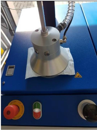
Abbildung 1: Bestimmung der Abscheideleistung von Masken, links: Prüfaufbau, rechts: medizinische Gesichtsmaske(MNS)
